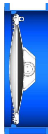
Разрез в положении «Закрыто» затворов для диаметров ≥1200
