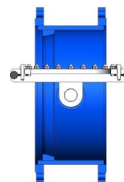
Разрез в положении «Открыто» затворов для диаметров ≤1200
